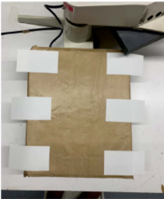
Verifique se a sua prensa está com pressão consistente e uniforme com este teste usando pedaços de papel.
